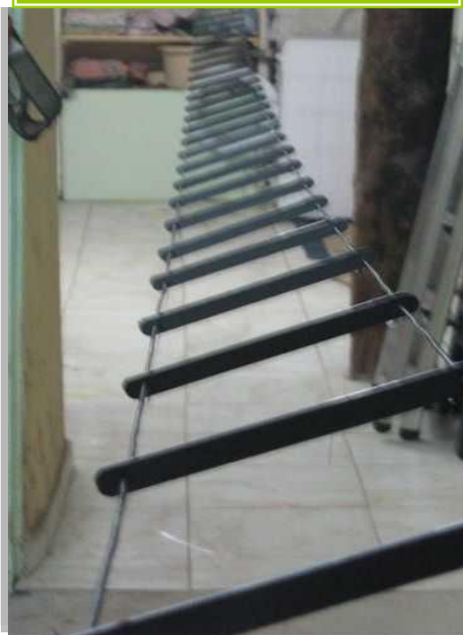
LE FEEDER EN CONSTRUCTION.
