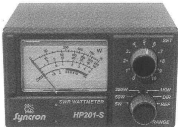
L'un des accessoires les plus courants dans les stations radioamateur : le ROS-mètre, indispensable appareil de mesure si vous voulez optimiser votre système d'antenne, et par là même protéger votre matériel d'émission-réception.
