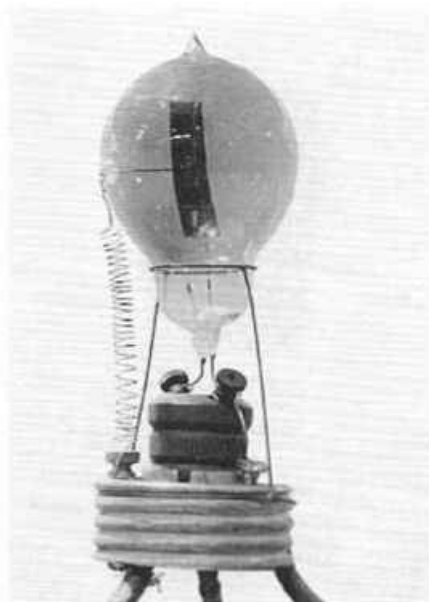
De l'audion de Lee de Forest à la triode de Fleming et aux premières lampes de puissance opérationnelles.
